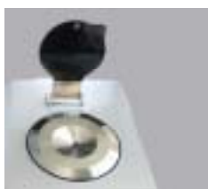
1. Vérification du prisme.
