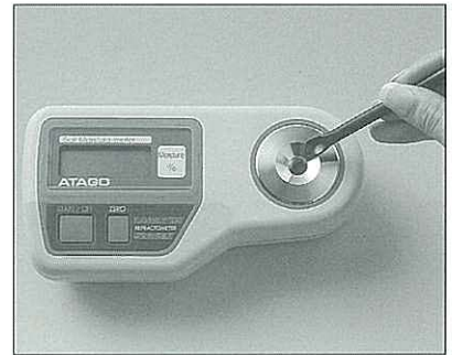
3. プリズム面に土壤測定用濾紙を置き、その上にグリセリンを滴下します。
