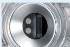
光の屈折から濃度(Brix)を測定する屈折方式には光学プリズムを、電気の流れから塩分濃度を測定する電気伝導度方式にはチタンを採用しました。
