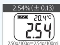
2.50g/100gの食塩水を測定し、2.54 ± 0.13% が表示されることを確認します。測定値が異なっていた場合、基準合わせができる機能を搭載しています。
