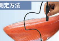
本器は、プローブを魚肉に挿し込むことにより、魚肉に浸透している塩分%をデジタル表示します。
