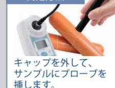
キャップを外して、サンプルにプローブを挿します。
