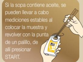
Si la sopa contiene aceite, se pueden llevar a cabo mediciones estables al colocar la muestra y revolver con la punta de un palillo, de allí presionar START.
