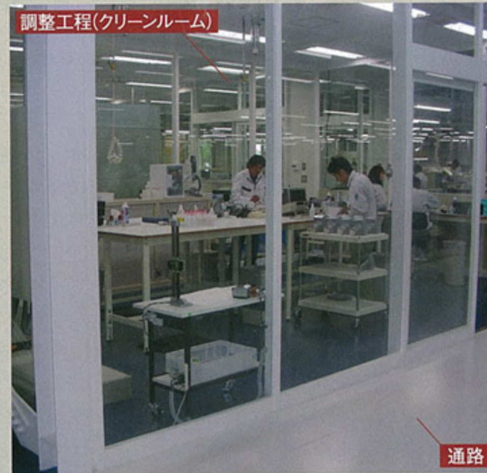
図D●ガラス張りのクリーンルーム 温度を一定に保ち、屈折計の調整を行う。全方位がガラス張りになっているので、内部の様子を一目で把握できる。
