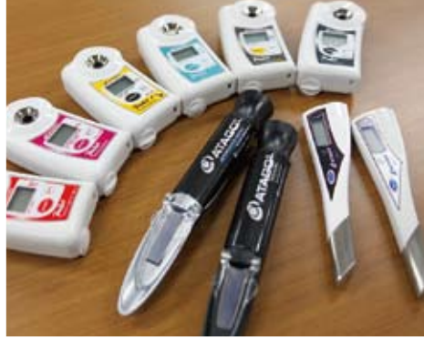
左上が測定対象に合わせて、100種類以上のラインナップがあるポケット糖度・濃度計。手前中央はアナログ式手持ち屈折計、右は2008年発売のペン糖度・濃度計。
