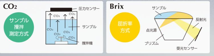
CooRe = Coo — CO<sub>2</sub> を意味しガスボリューム計 Re — Refractometer の略で屈折計
